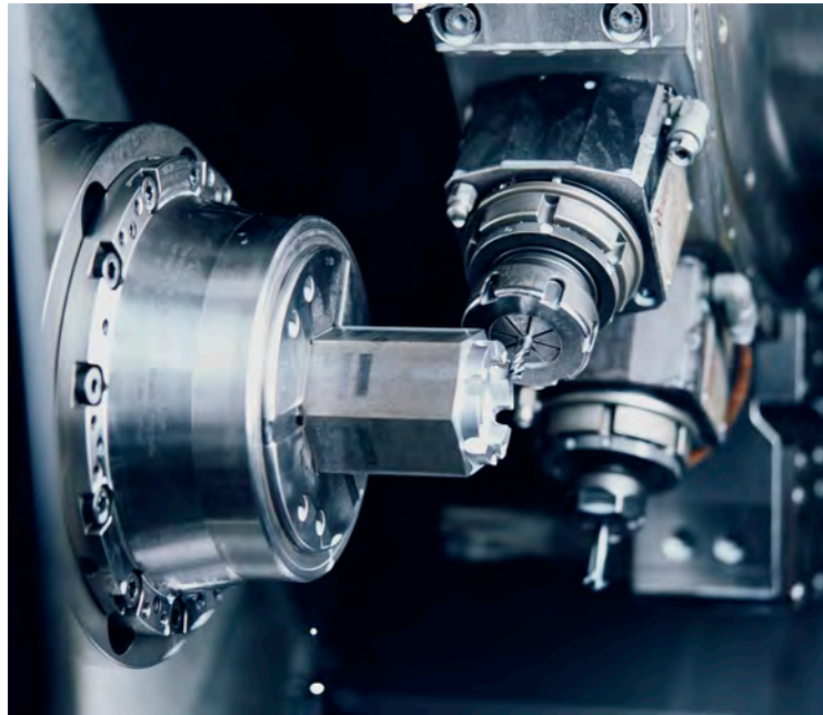
Drehen und Fräsen komplett in einer Aufspannung – exakt und ökonomisch
