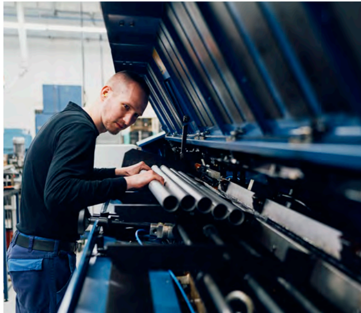
Stangenmagazin bis zu 3 Metern Länge
